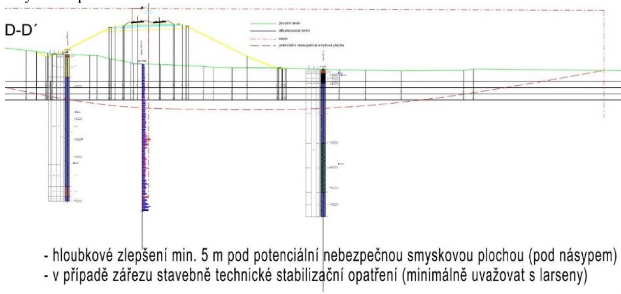
Obr. 5.3-.10 Příčný řez D-D' v km 111,820 s vykreslenou potenciálně nebezpečnou smykovou plochou-
